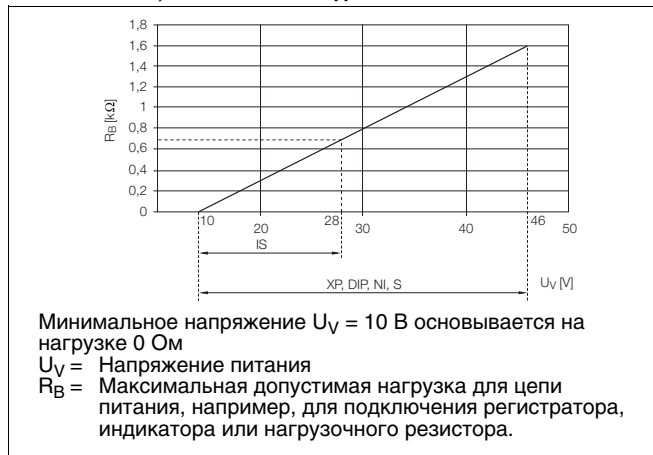
Рис. 25: Взаимосвязь между напряжением питания и нагрузкой.
