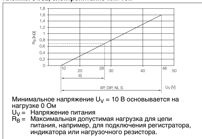
Рис. 29: Связь между напряжением питания и нагрузкой.
